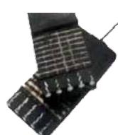
El principal riesgo de las bandas de cable de acero es la posibilidad de penetración entre los cables de objetos cortantes extraños que desgarren la banda en toda su longitud.
